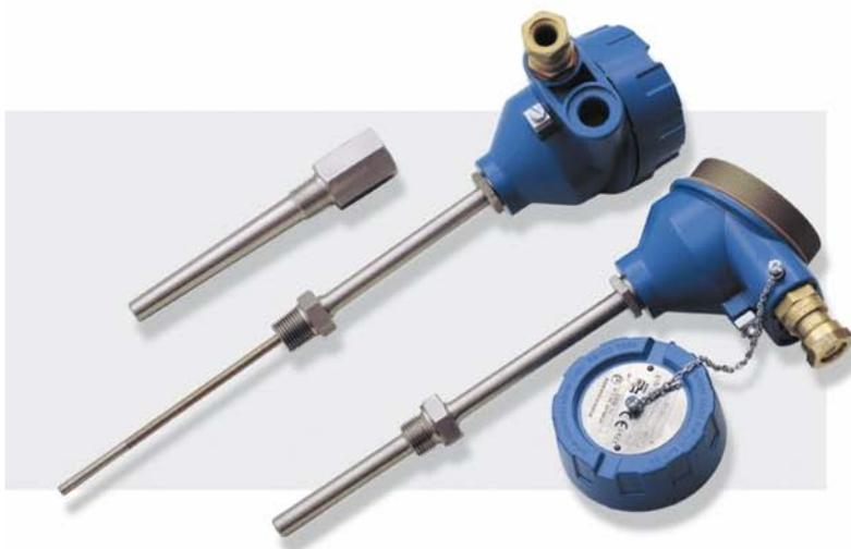
Thermoelemente und Widerstandsthermometer in explosionsgeschützter Bauform sind für Temperaturmessung in explosionsgefährdeten Zonen (z.B.: Gase, Nebel, Dampf und Staub) vorgesehen. Der Anschlusskopf für ATEX EExi und EExd ist mit 1 oder 2 Kabeleinführungen lieferbar. Im Kopf kann ein Klemmsockel und/oder Messumformer eingebaut werden. Anschlussköpfe für Zulassung ATEX-EExi können mit erhöhtem Deckeldom geliefert werden. Hier können 2 Messumformer installiert werden.
