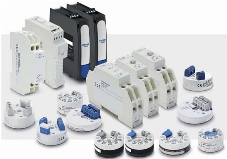
Unsere Temperatur-Messumformer wandeln das Sensor-signal in ein Ausgangssignal 4-20 mA-, 4-20 mA + HART-, 0-10 V und/oder ein Profibus PA-Signal. Die Messumformer können mit Universaleingang für Widerstandsthermometer oder auch Thermoelement geliefert werden. Lieferbar auch mit Zulassung ATEX EExi a/b.
